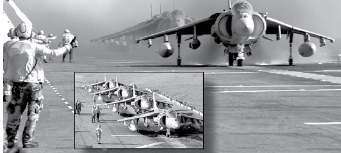
Для ВКР группы «Харриеров» с АНК с максимальным темпом взлета, они устанавливались по осевой линии друг за другом на минимально безопасном (с точки зрения попадания горячих газов в воздухозаборники) расстоянии и последовательно взлетали
