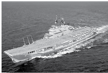
При ВКР группы «Харриеров» с АНК с максимальным взлетным весом они устанавливались полукругом рядом с кормовым срезом палубы и поочередно вытаскивали на кормовую стартовую позицию
